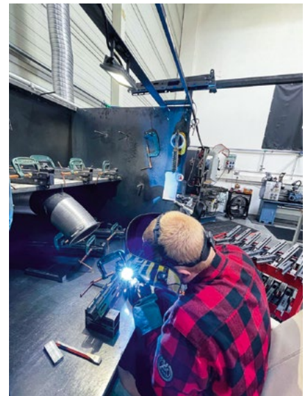
Svařování dílů lisované části rámu
