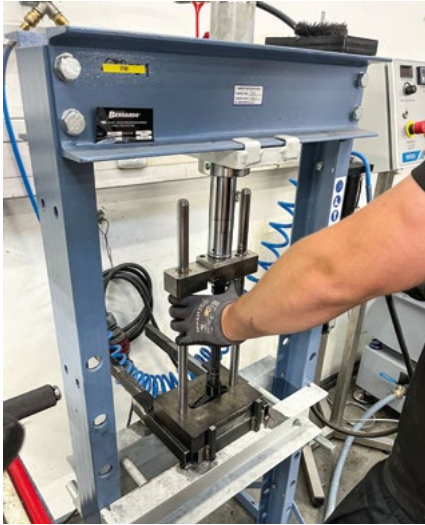
Lisování plynového nástavce na hotovou hlavěň
