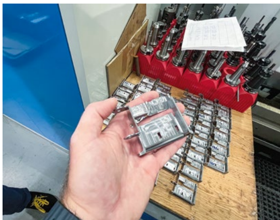
Obrobený nábojový stůl před kontrolou rozměrů
